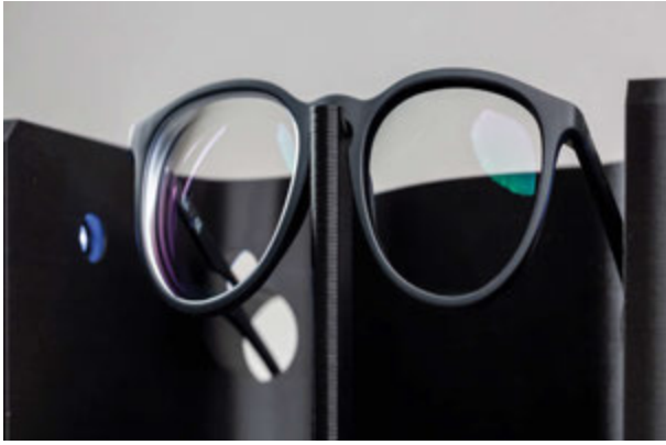
Abb. 7: Die absorbierende Randbeschichtung des linken Glases eliminiert das über Front- und Rückfläche eintretende Licht und blockt das von außen auf den freiliegenden Brillenglasrand treffende Licht. Das rechte Glas mit unbehandeltem Glasrand zeigt die üblichen Myopieringe. Brille mit identischen Gläsern (-2,00 dpt, n = 1,5 ) im GlareVis-Demonstrator.
