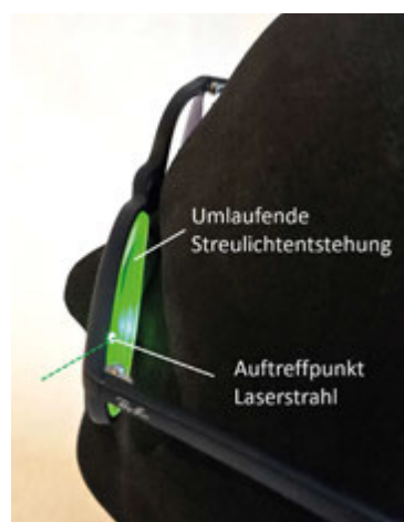
Abb. 5: Tritt Licht über einen freiliegenden Teil des Rands in das Brillenglas ein, breitet es sich durch Totalreflexion über den gesamten Glasrand aus.
